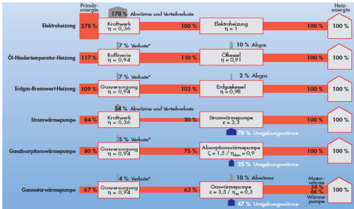
Abbildung 124: Primärenergieeinsatz verschiedener Heizsysteme (Warmwasserbereitung nicht berücksichtigt) (ASUE 2002)
